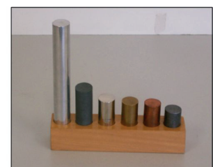
Fig. 2 : Cylindres formés de différents matériaux de même masse
