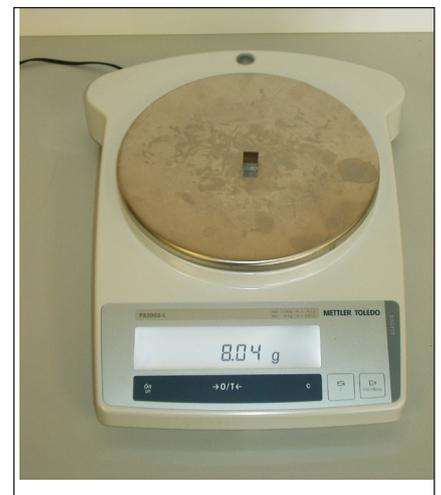
Fig. 1: Le cube sur la balance a une arête de 1 cm. Son volume est alors de  $1 \text{ cm}^3$ .
