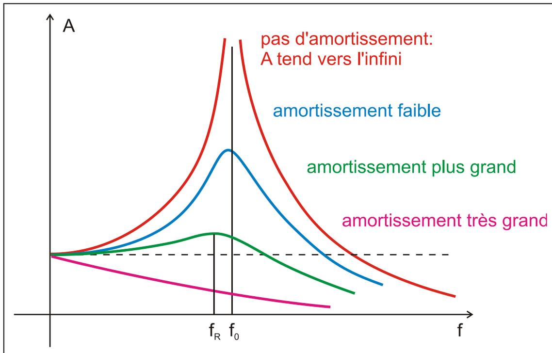
La courbe de l'amplitude  $A$  du résonateur en fonction de la fréquence  $f$  de l'excitateur :  $A(f)$  est appelée **courbe de réponse** du résonateur.
